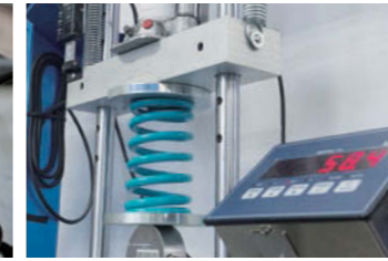
ทีมงานไนตรอนจะทำการผลิตโช้คไนตรอนขึ้นมาหลังจากที่ตรวจวัดแรงพ่นกำลังลักษณะเฉพาะของตัวโช้คออริจินัล และได้รับข้อมูลมาทั้งหมด
