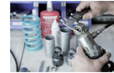
ทีมงานไนตรอนจะทำการผลิตโช้คไนตรอนขึ้นมาหลังจากที่ตรวจวัดแรงพ่นกำลังลักษณะเฉพาะของตัวโช้คออริจินัล และได้รับข้อมูลมาทั้งหมด
