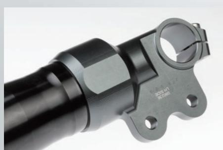
高剛性7000番台のアルミを用いたアウターチューブと鍛造で作られたフォークボトム。
