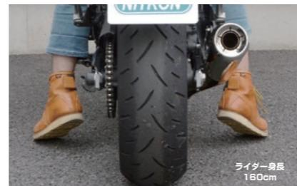
スタンダード比30mmの大幅ダウンにより、抜群の足つき性を実現。最低地上高も115mmを確保。
