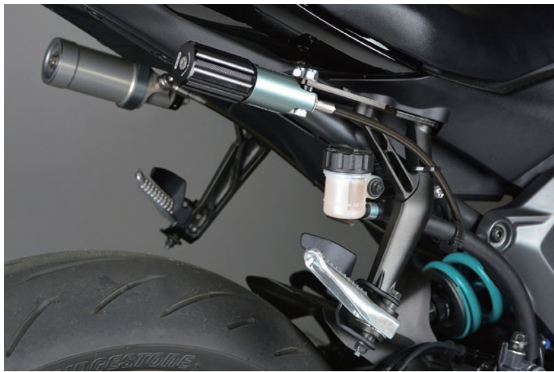
Fitting Image (R3 Series) 写真のリザーバタンク、ハイドロリックプリロードスターはサンプルとなります。
