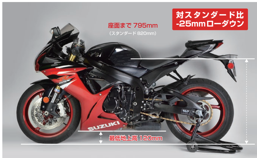
写真はR3シリーズでイメージとなります。フロントフォークを3mm突き出しを推奨します。
