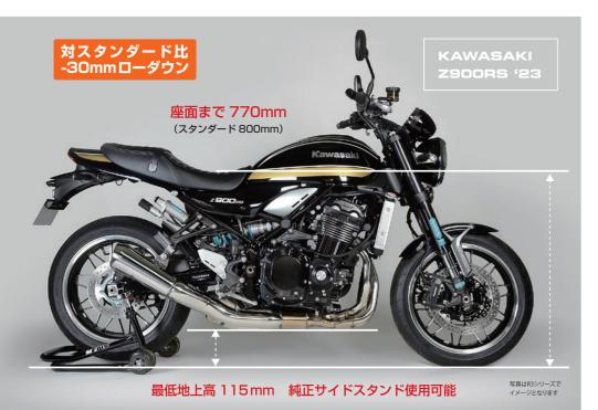
スタンダード比30mmの大幅ダウンにより、抜群の足つき性を実現。最低地上高も115mmを確保。 大型車のため座面が高いZ900RSをさらに快適にコントロールできます。
