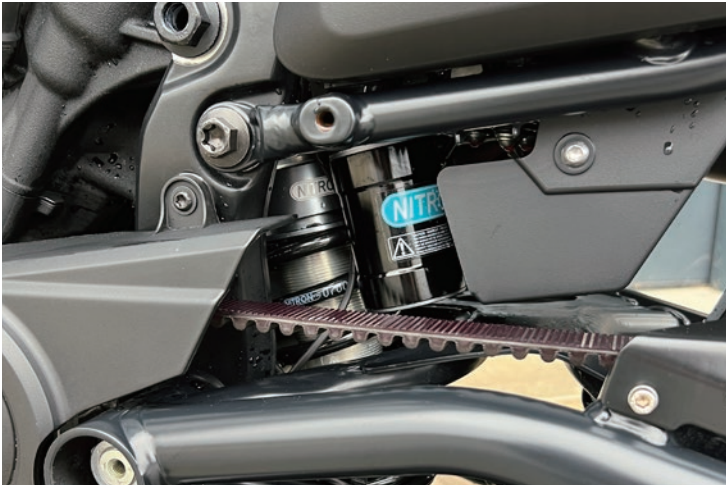
R3 Series ¥262,900 (税抜 ¥239,000) NTBKH05R-TQ/TB 3way ダンピングアジャスター搭載 / 別体リザーバタンクモデル / 油圧式プリロードアジャスター標準装備モデル / 車高調整アジャスター
