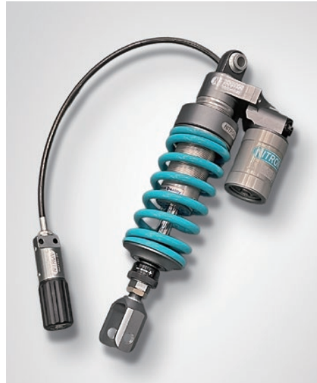
R3 Series ¥262,900 (税抜 ¥239,000) NTBKH05R-TQ/TB 3way ダンピングアジャスター搭載 / 別体リザーバタンクモデル / 油圧式プリロードアジャスター標準装備モデル / 車高調整アジャスター
