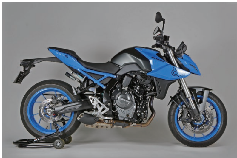
R3 Series ¥235,400 (税抜¥214,000) NTBKS70R-TQ/TB 3way ダンピングアジャスター搭載 / 別体リザーバタンクモデル 油圧式プリロードアジャスター / 専用ブラケット標準装備モデル / 車高調整アジャスターは付属していません
